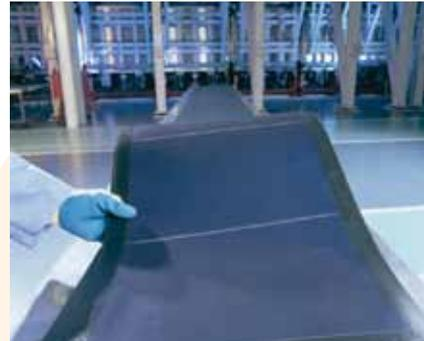
Las células de capa fina pueden ser hasta 300 veces más delgadas que las cristalinas, por lo que requieren menos material. El proceso de deposición en vacío usa una temperatura de proceso menor que los sistemas tradicionales, lo que ahorra energía en su producción. Por tanto, comparadas con productos FV cristalinos convencionales, las células de capa fina *UNI-SOLAR* tienen un mejor balance energético, lo que revierte en una mayor contribución a la protección del medio ambiente.
