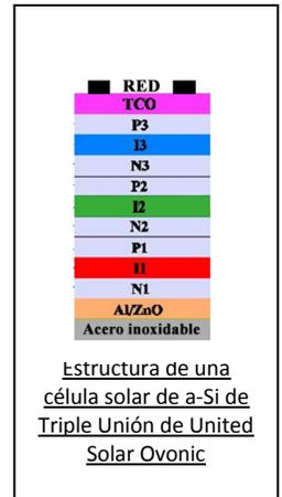
Como resultado de esta estructura única de células y módulos, los productos de United Solar Ovonic no se ven afectados por la corrosión de la capa de TCO y no es necesario conectar a tierra el módulo a través de un polo negativo para evitar que los módulos sufran daños. (Nota: la conexión a tierra del módulo puede ser un requisito de los códigos eléctricos aplicables en la zona de instalación del sistema.)
